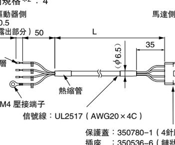
50mm L<br>馬達側<br>防止芯線散亂用包層<br>熱縮管<br>M4 壓接端子<br>信號線 : UL2517 ( AWG20 × 4C )<br>保護蓋 : 350780-1 ( 4針腳 )<br>插座 : 350536-6 ( 鏈狀 ) |       |
