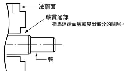
\*：軸貫通部分除外。或者僅在使用專用信號線時，符合保護結構規格。
