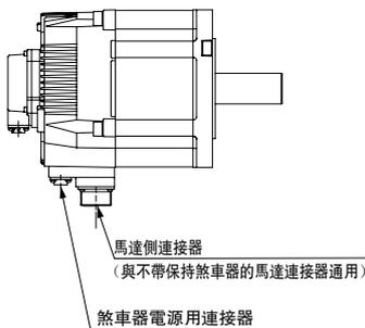
煞車器電源用連接器
