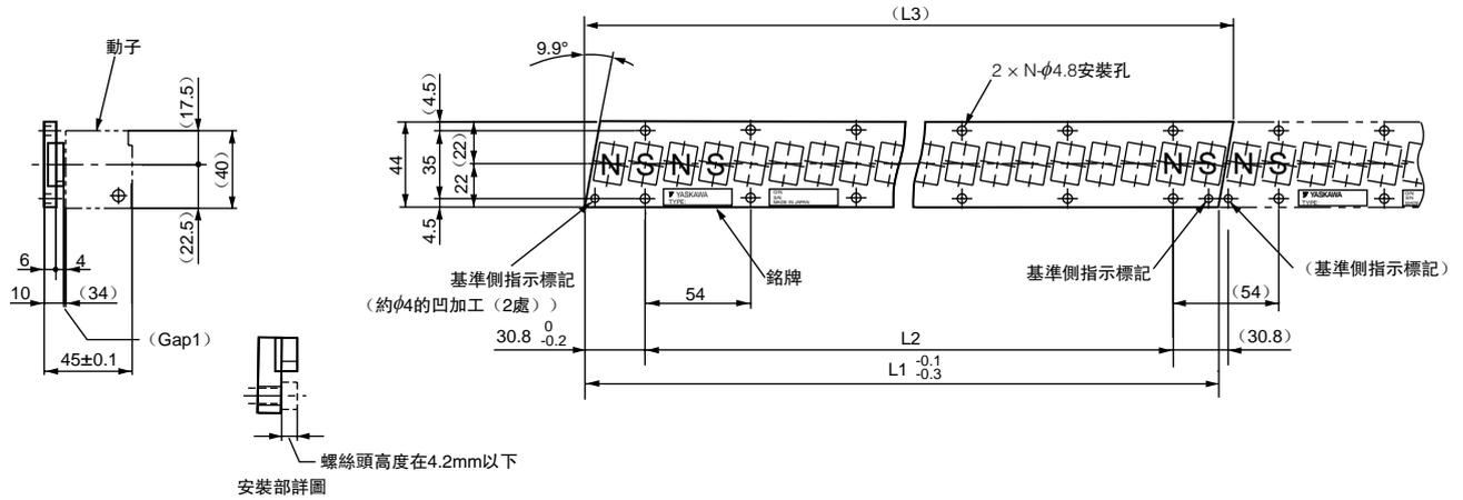
(註) 1 定子可連接。此時，請使基準側指示標記與上圖所示的方向一致後再使用。
