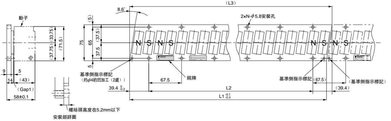
(註) 1 定子可連接。此時，請使基準側指示標記與上圖所示的方向一致後再使用。
