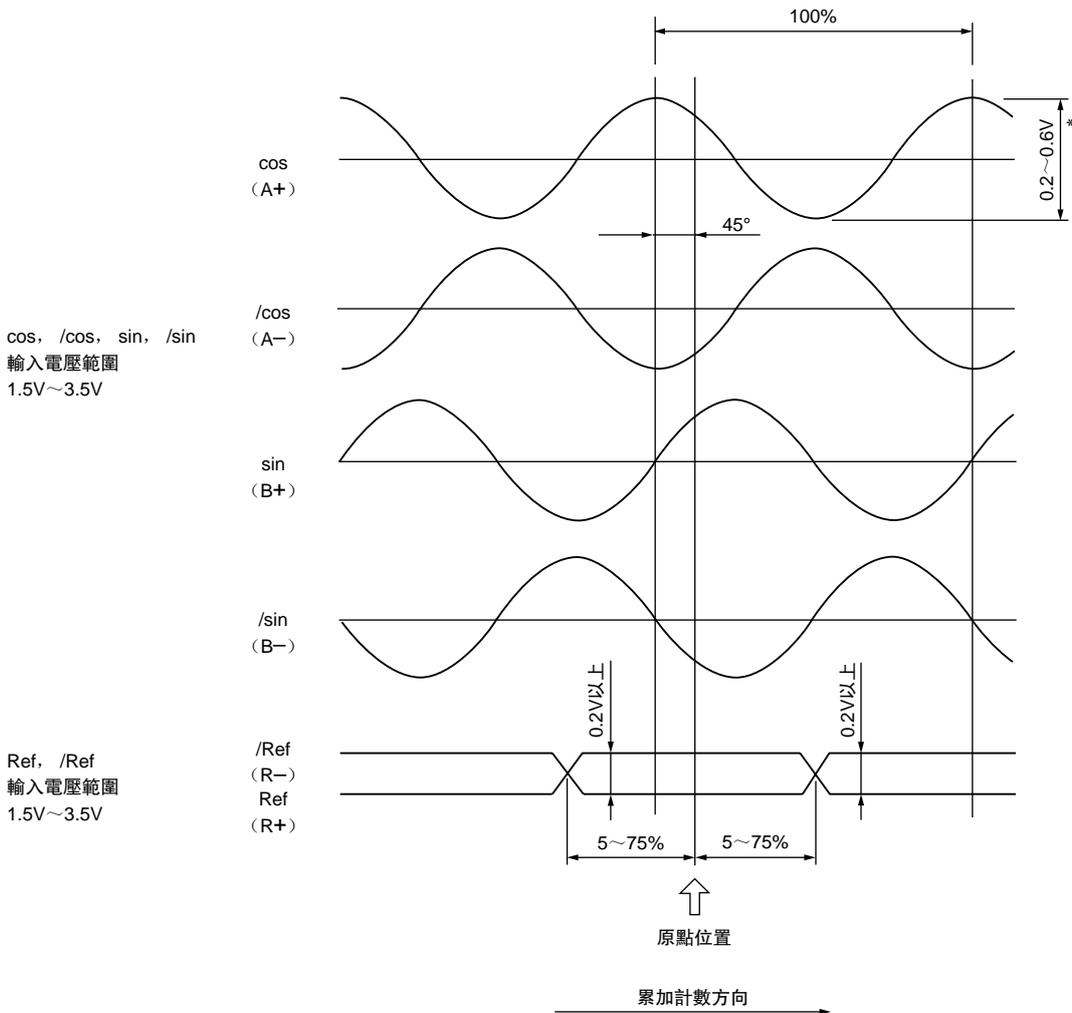
\*：因差動振幅的緣故而使類比信號振幅降低至約 0.35V 時，串列轉換單元將輸出警報。
