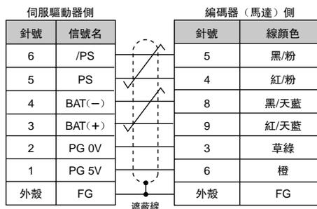
(2) 兩端帶連接器的信號線接線規格 (絕對值用：帶電池單元)
