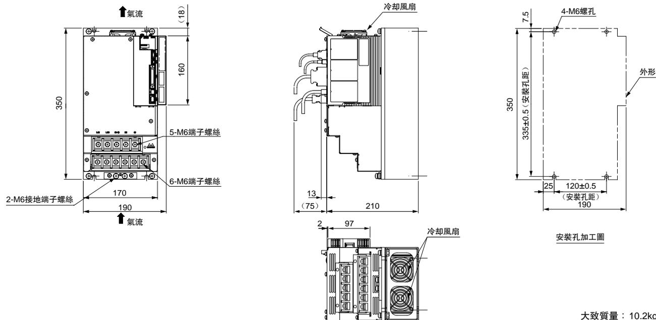
(10) 三相 AC200V SGD V590A□□A000000□□□, SGD V780A□□A000000□□□
