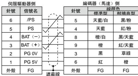
(2) 兩端帶連接器的信號線接線規格：750W, 1.5kW
