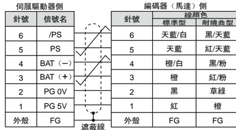
(3) 兩端帶連接器的信號線接線規格：100 ~ 400W
