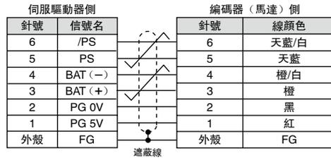
(3) 帶電池單元的信號線接線規格
