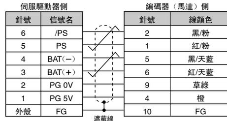
(2) 兩端帶連接器的信號線接線規格 (絕對值用: 帶電池單元)
