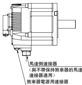
煞車器電源用連接器
