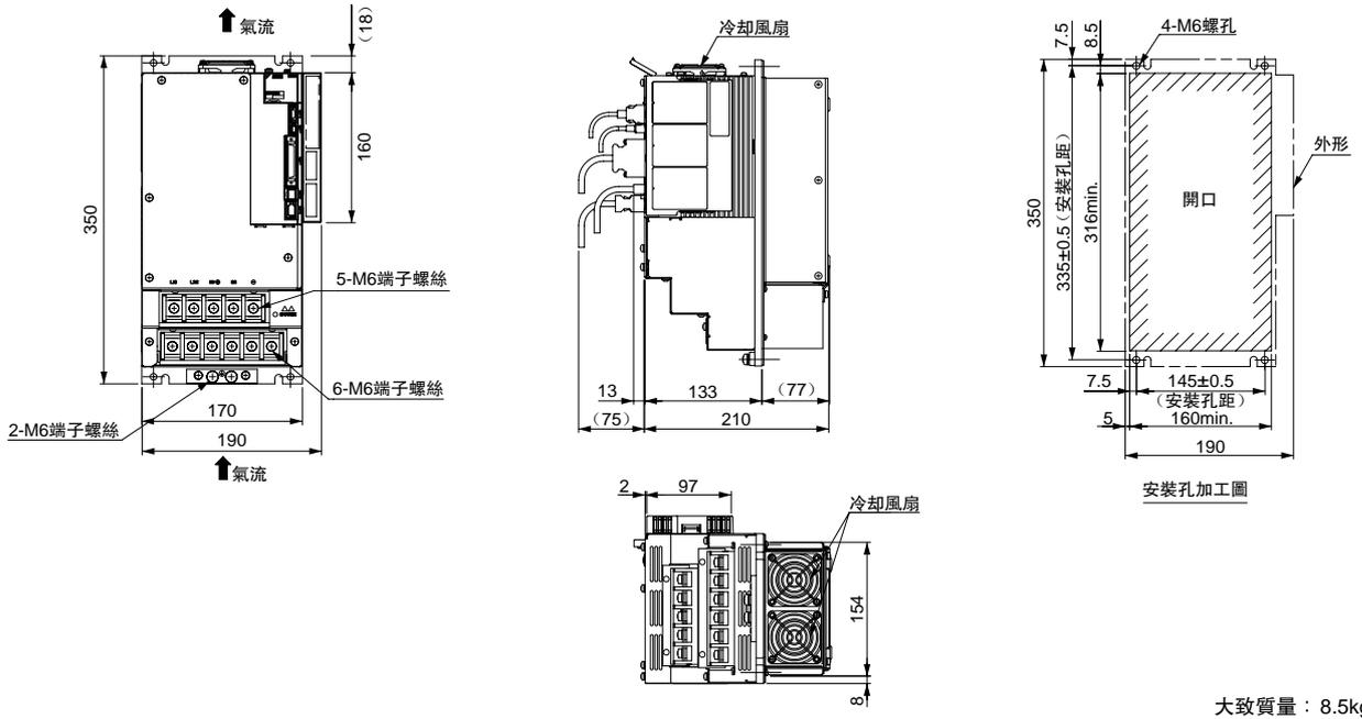
(10) 三相 AC200V SGD V590A□□A001000□□□, SGD V780A□□A001000□□□ (通風管道型)
