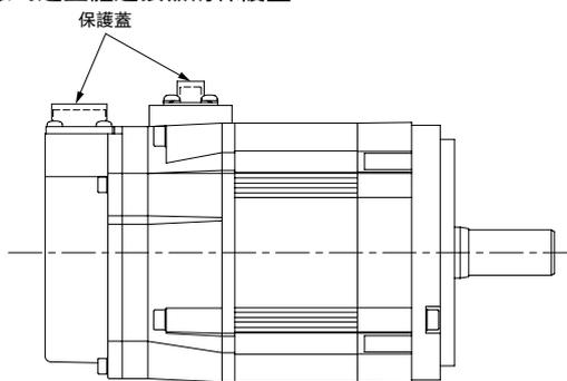
**步驟 2** 請如下圖所示，在伺服馬達上安裝信號線連接器並旋緊螺絲。
