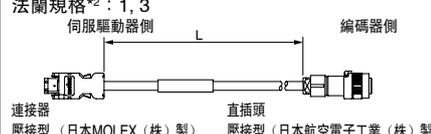
直插頭<br>壓接型 (日本 MOLEX (株) 製) 壓接型 (日本航空電子工業 (株) 製) | (1)  |
