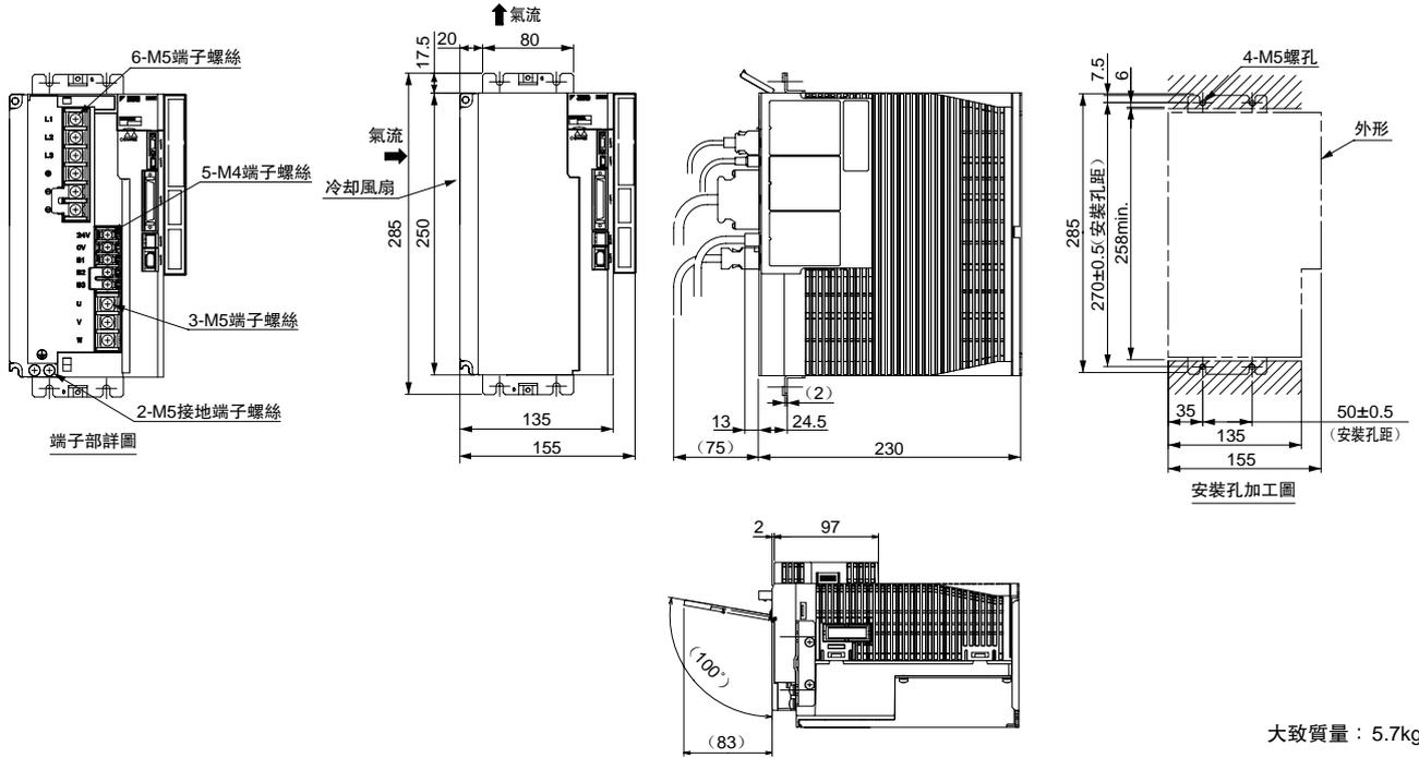
(14) 三相AC400V SGD210D□□A001000□□□, SGD260D□□A001000□□□ (通風管道型)
