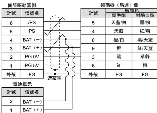
(4) 兩端帶連接器的信號線接線規格：750W, 1.5kW
