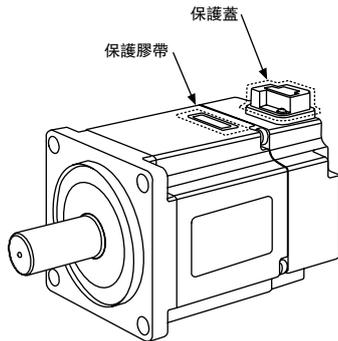
**步驟 2** 請如下圖所示，在伺服馬達上安裝信號線連接器並旋緊螺絲。
